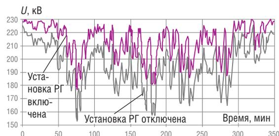
Рис. 5. Изменение фазного напряжения понизительной подстанции при движении поездов
