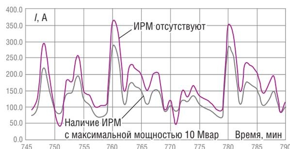
Рис. 6. Токи фидера контактной сети левого плеча одной из тяговых подстанций расчетного полигона при движении 72 пар поездов
