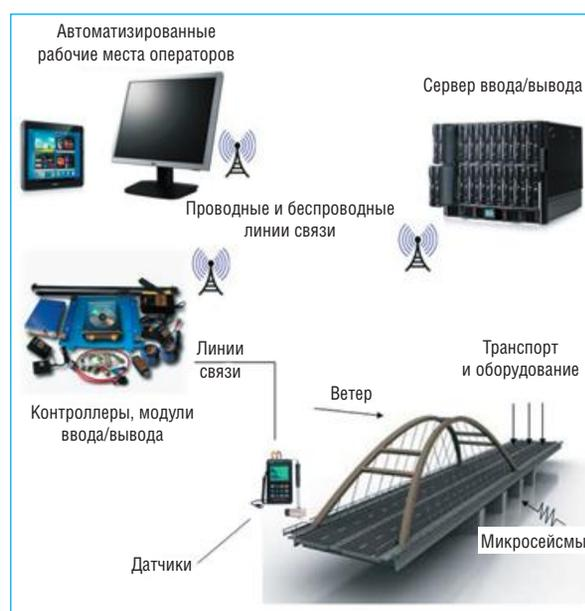
Рис. 1. Системы мониторинга искусственных сооружений
