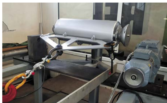
Рис. 1. Пружинный компенсатор со встроенным тормозом
