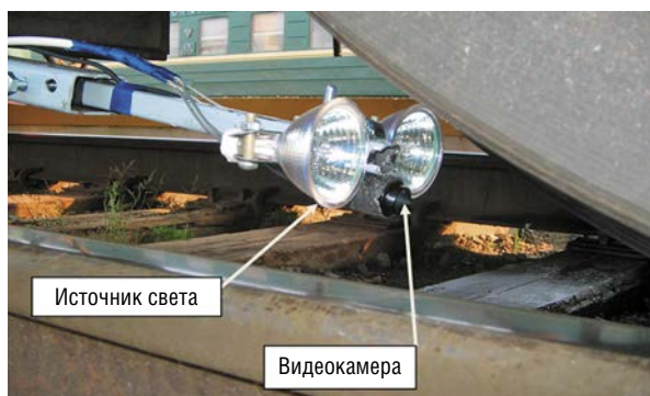
Рис. 3. Конструкция для определения перемещения колесной пары поперек колеи (вид спереди)
